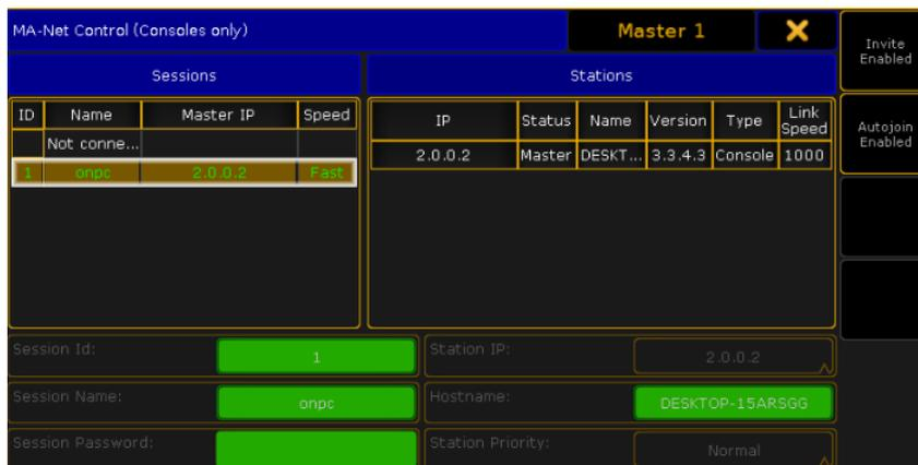
将 MA2 灯光控台设置成 2 段 IP。
