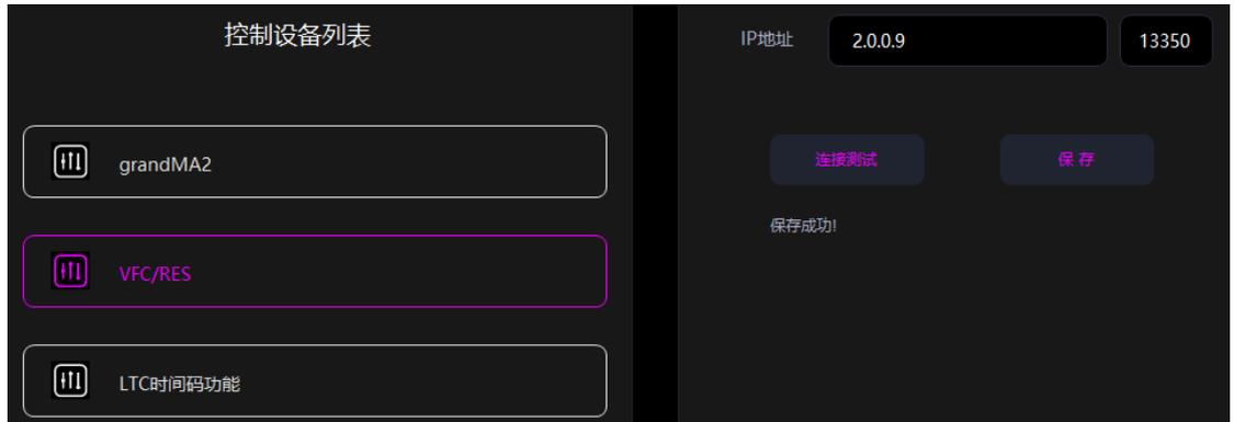
IP 地址输入框，输入 VFC/RES 视频服务器的 IP 地址。
